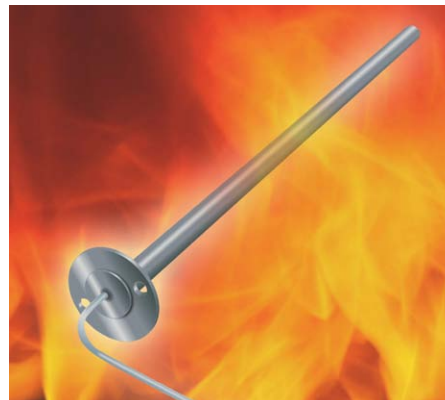
System ECO – efektywna kontrola i optymalizacja spalania poprzez czujnik temperatury płomienia i pomiar podciśnienia. Kontrola komory spalania czujnikiem temperatury w samej komorze umożliwia optymalne i szybkie dopasowywanie spalania do zmiennej jakości paliwa.
