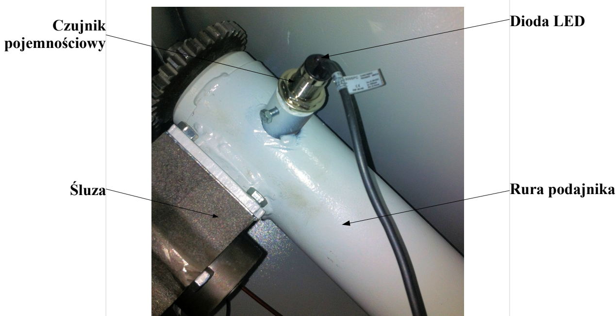
Rys nr 5. Umieszczenie pojemnościowego czujnika zbliżeniowego
