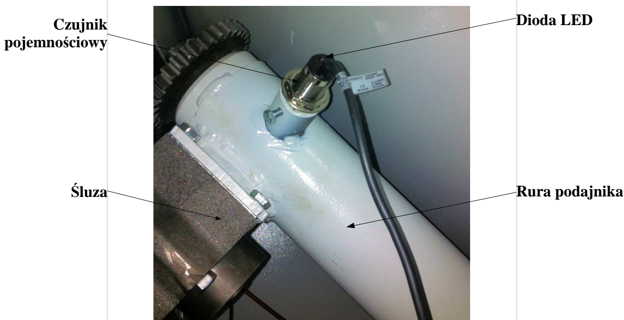
Rys nr 5. Umieszczenie pojemnościowego czujnika zbliżeniowego
