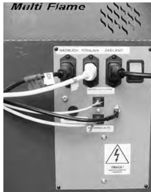
Rysunek 3 Moduł sterujący pracą palnika.
