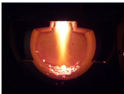
Płonienie płomienia w dolnej komorze spalania w przestrzeni kulistej
