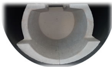
Widok dolnej komory do dokładania
