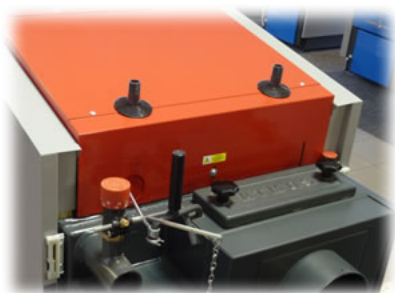
Pętla chłodząca przeciwko przegrzaniu
